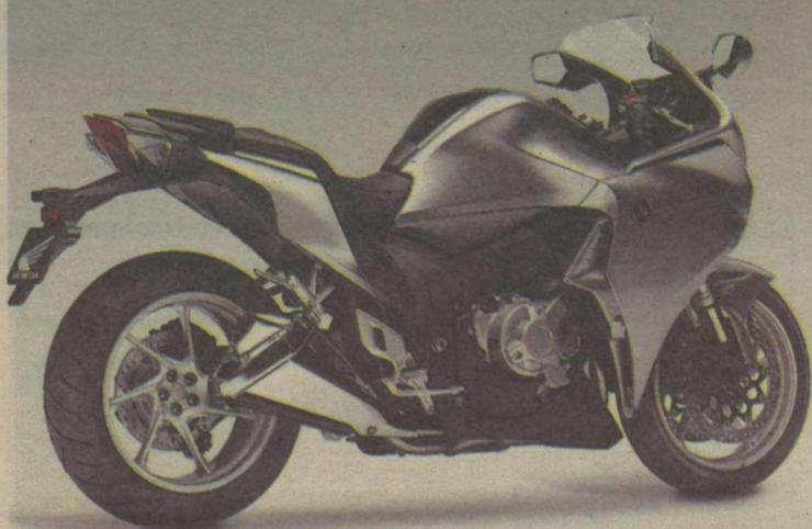
A carenagem integral e o para-brisa regulável aumentam o conforto aerodinâmico
