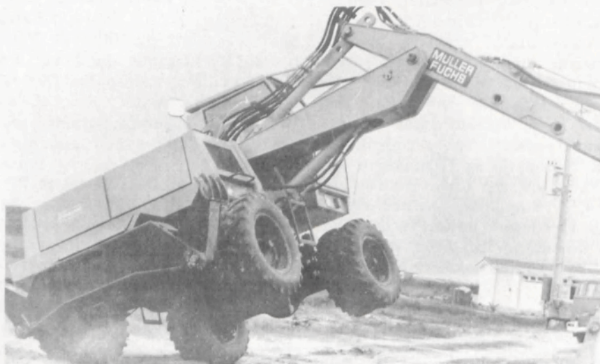
A MULLER FUCHS tem super-estrutura giratória de acionamento hidráulico, o que possibilita a sua operação em qualquer posição dos 360 graus de seu giro
