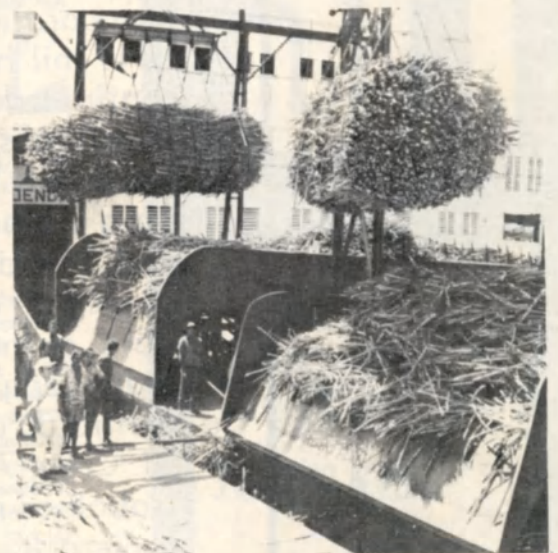
Murilo Tavares de Melo, um dos diretores da empresa, mostra por que a Usina Estivas está entre as maiores do Nordeste. A direita, foto da ponte rolante com as respectivas casas de cana, com capacidade de armazenar 1.200 toneladas.
