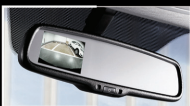
CÂMERA DE RÉ COM SENSOR DE DISTÂNCIA E DISPLAY DE LCD NO RETROVISOR.
